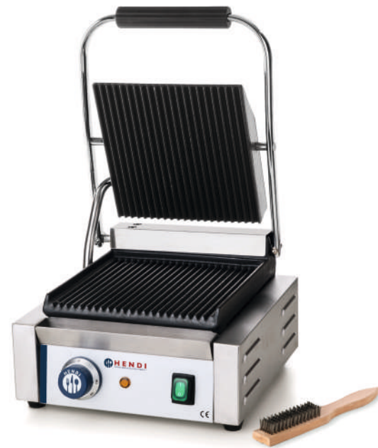
Grill kontaktowy pojedynczy ( marka Hendi, kod produktu 263501) górze i dół ryflowane, 230V, 1800W, wymiary: 290 x 370 x 210(H)
