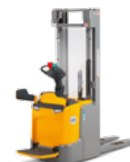
ERC 212-220* Podnośnikowy wózek widtowy maks. wys. podn.: 6 000 mm maks. udźwig: 2 000 kg
