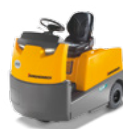
EZS 570–5100 Ciągnik akumulatorowy maks. uciąż: 10 000 kg
