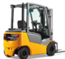
DFG/TFG 316–320 Wózek z przekładnią hydrodynamiczną maks. wys. podn.: 7 500 mm maks. udźwig: 2 000 kg
