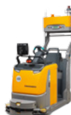
EZS 350a Automatyczny ciągnik maks. uciąż: 5 000 kg
