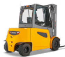
EFG 535k–S50 Czołowy czterokołowy wózek widłowy maks. wys. podn.: 7 500 mm maks. udźwig: 5 000 kg
