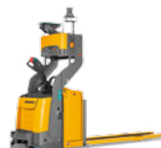
ERE 225a Automatyczny wózek unoszący maks. wys. podn.: 122 mm maks. udźwig: 2 500 kg
