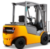
DFG/TFG 425–435 Wózek z przekładnią hydrodynamiczną maks. wys. podn.: 7 500 mm maks. udźwig: 3 500 kg
