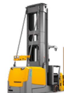
EKX 514a–516a Automatyczny wózek do składowania w regałach maks. wys. podn.: 13 000 mm maks. udźwig: 1 600 kg
