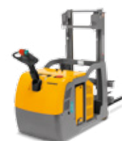
EJG 106-216 Podnośnikowy wózek widtowy maks. wys. podn.: 5 350 mm maks. udźwig: 1 600 kg
