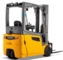
EFG 213–220 Czołowy trójkołowy wózek widłowy z napędem przednim maks. wys. podn.: 7 000 mm maks. udźwig: 2 000 kg
