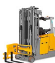
ETX 513–515** Wózek systemowy z obrotową karetką widet maks. wys. podn.: 13 000 mm maks. udźwig: 1 500 kg
