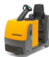
EZS C40 Ciągnik akumulatorowy maks. uciąż: 4 000 kg
