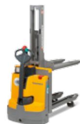
EMD 115i/118 Podnośnikowy wózek widtowy podwójnego załadunku maks. wys. podn.: 1 520 mm maks. udźwig: 1 800 kg
