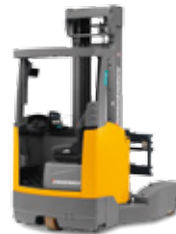
ETV Q20/Q25 Wózek widtowy wysokiego składowania, jazda wielokierunkowa maks. wys. podn.: 10 700 mm maks. udźwig: 2 500 kg
